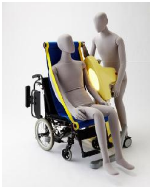
図表-2-③ 移乗システム ROBOHELPER SASUKE の外観
